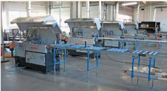
Die Aluminiumsägen garantieren maßgenauen Serienschchnitt.
