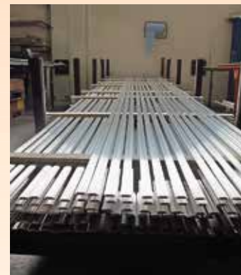
Die sechs Meter langen Aluminiumprofile werden in der Sägerei auf Maß geschnitten.
